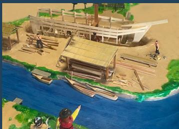
按針は伊東の街の中心を流れる松川の河口付近で西洋式帆船を造りました。その建造方法は、砂地を掘り下げて丸太をひき、砂ドッグをつくり、その中で船を組み立てる方法で、船が出来上がった後は川をせき止めて、水をドッグ側に流すことで船を進水させます。按針は80tと120tの2隻の西洋式帆船を伊東で造りました。2隻目は「サン・ブエナ・ベンツラ号」と名づけられメキシコまで航海しました。
